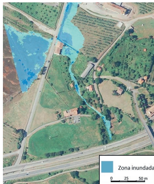
Figura 5 | Situación actual en el vertido norte para un periodo de retorno de 100 años ( Q_{100} ).
